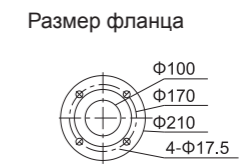
Размер фланца Фланец по стандарту GB/T17241.6PN6
