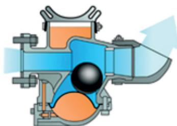
В течение следующих 20 секунд давление в двух камерах уравнивается и шар поднимается мембранный. Время, которое займет этот процесс, может регулироваться.
