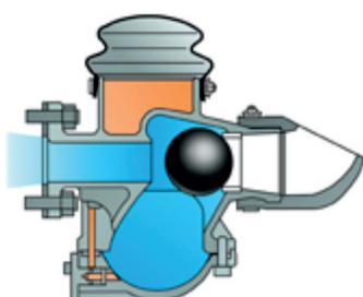
Шар достигает критической точки и под воздействием потока вынужден вернуться на место, таким образом, закрывая клапан. Мощность насоса в этот момент полностью направлена на удаление осадка из зумпфа и давление внутри клапана выдавливает мембранны на исходную позицию.
