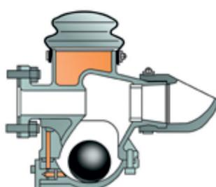
Когда насос останавливается, давление внутри клапана ослабевает и шар падает в положение покоя. Теперь клапан открыт и готов к следующему старту насоса.
