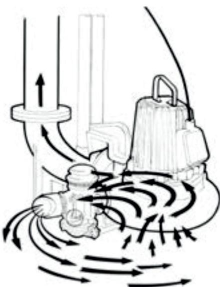
Когда происходит запуск насоса, клапан открывается примерно на 30 секунд, выпуская мощную струю, которая поднимает твердые частицы во взвешенное состояние для последующего перекачивания.
