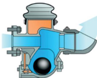
В момент пуска насоса клапан открыт. Поток воды проходит через клапан, создавая разреженное давление в камере шара по сравнению с давлением в масляной камере под мембраной.
